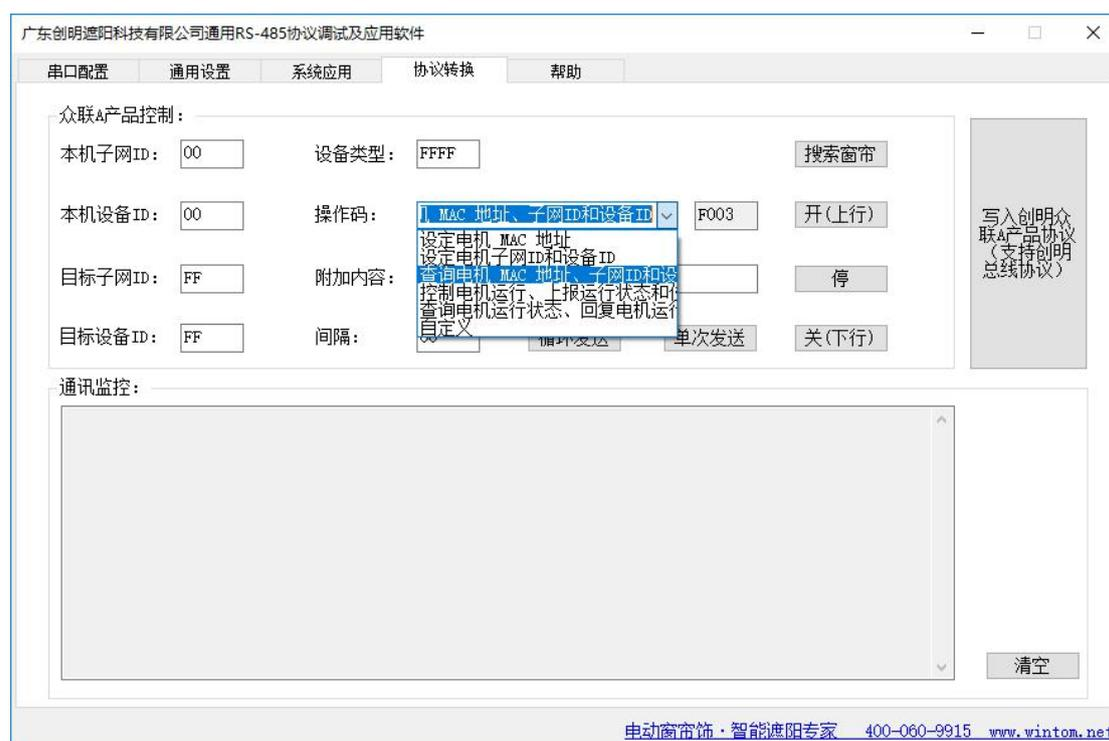
接着点击“单次发送”，若操作成功，电机返回数据，若无请检查其他问题（接线、串口线、供电等等）。
