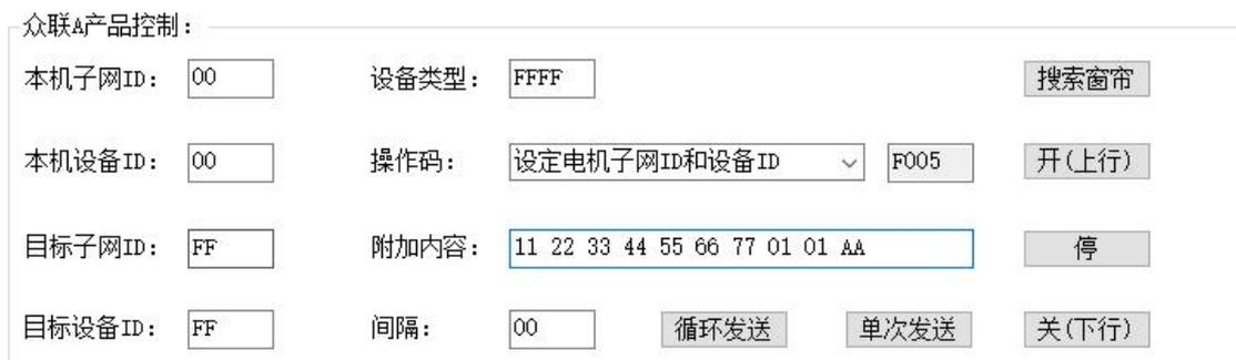
接着点击“单次发送”，若操作成功，电机返回数据，若无请检查其他问题（接线、串口线、供电等等）。
