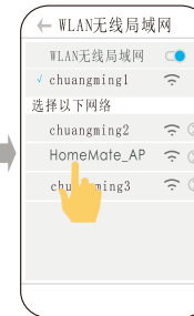
在家庭局域网连接状态下点击Home Mate_AP进行设备联网,连接后点击返回“智能窗帘”界面
